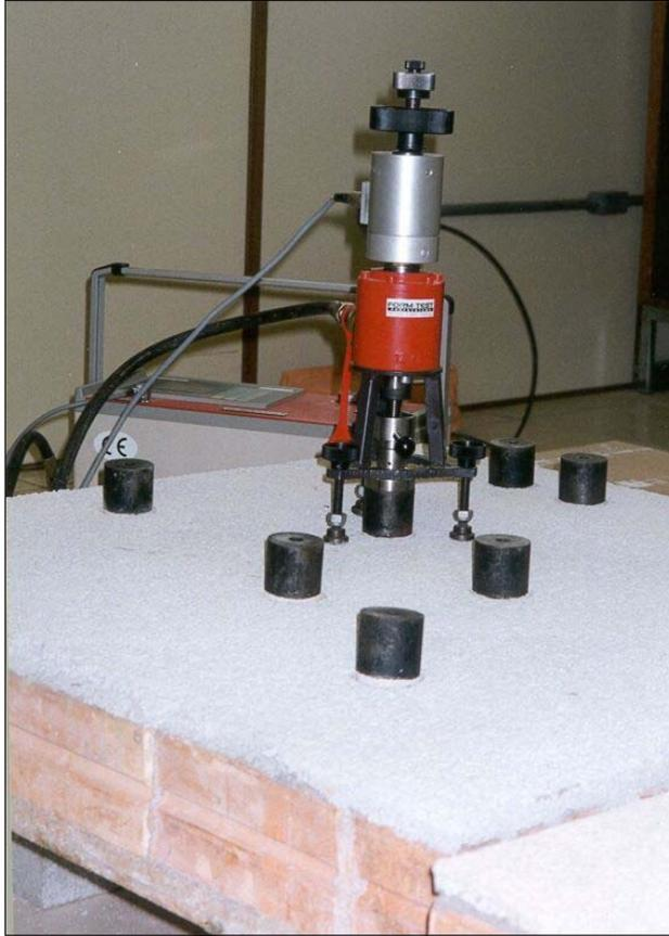
Figura 3.29 Equipamento utilizado no ensaio de aderência.
