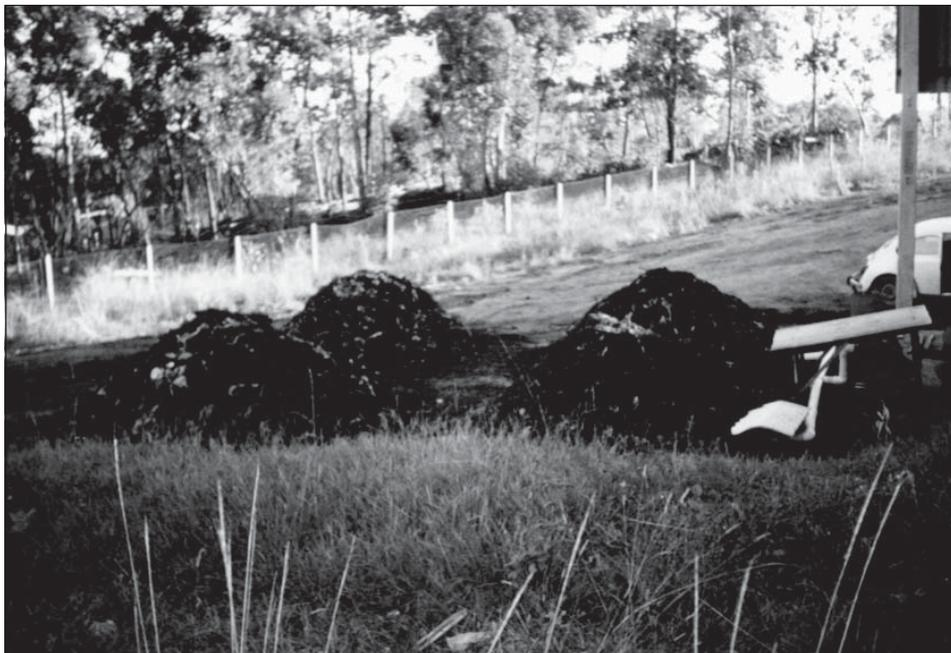
Figura 3.42 Montagem das quatro leiras em escala real.
