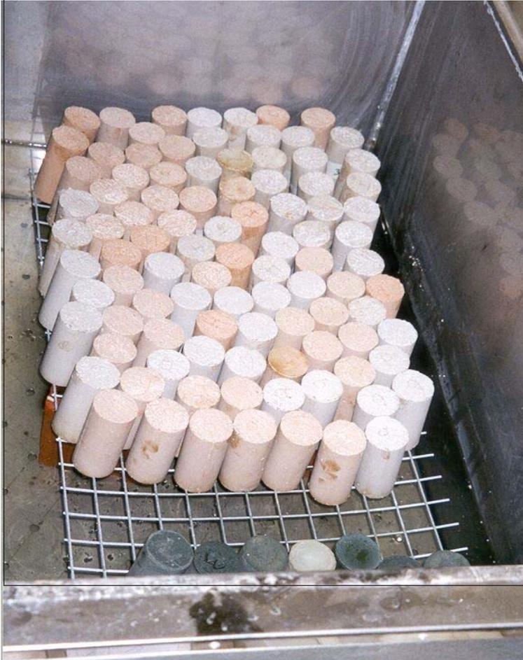
**Figura 3.27** Cura dos corpos-de-prova (câmara úmida).
