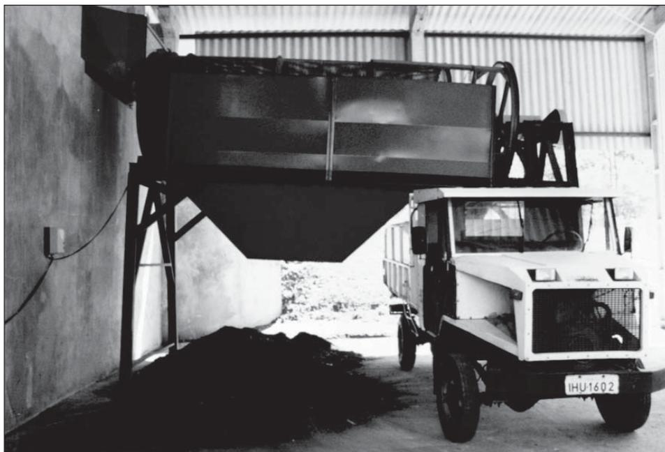
Figura 3.34 Peneiramento da unidade de triagem e compostagem
