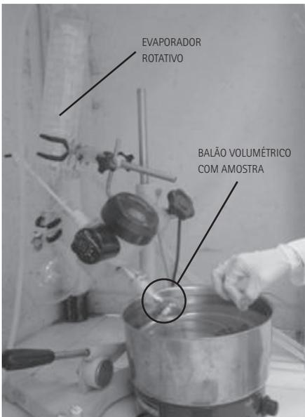
Figura 4 Evaporador rotativo
