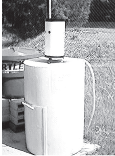
Figura 3.23 Pluviógrafo instalado no Parque Experimental do Núcleo Água
