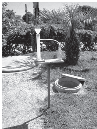
Figura 3.32 Foto representativa do pluviômetro instalado na residência em estudo
